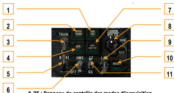
6-75 : Panneau de contrôle des modes d'acquisition
