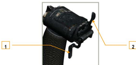
6-7 : Gâchettes des Munitions (grande) et du Canon (petite) en position Canon (Gâchette de Largage des Munitions (grande) relevée)
