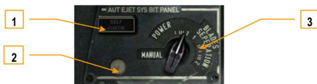
6-65 : Panneau de tests intégrés du système d'éjection automatique
