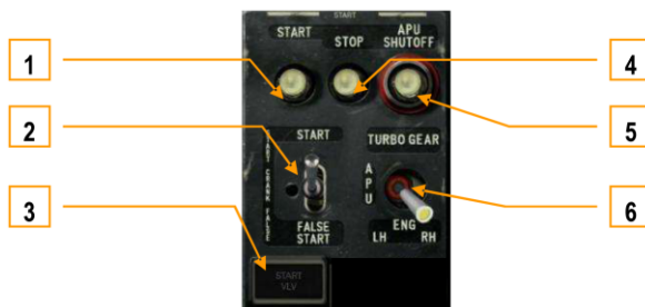
6-76 : Commandes de mise en route des moteurs
