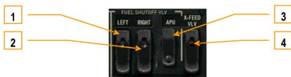
6-56 : Contrôles des vannes coupe-feu
