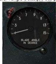
6-14 : Indicateur du pas des pales du rotor ENrE:
