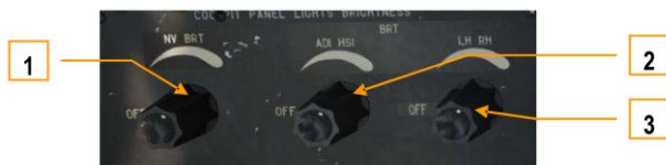
6-72 : Panneau de contrôle de l'éclairage du cockpit
