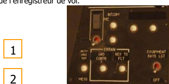
6-66 : Panneau de contrôle Intercom
