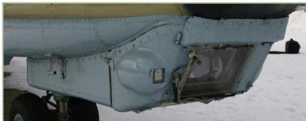
1-7 : Système de désignation TV automatique "Shkval" I-251V
