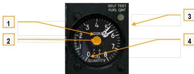
6-27 : Indicateur de quantité de carburant
