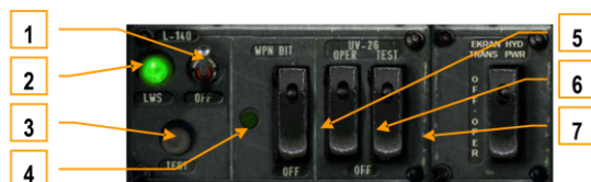
6-70 : Panneau de contrôles des équipements : système d'alerte laser L-410 (LWS), système armements (WS) et système de contre-mesures (UV-26).
