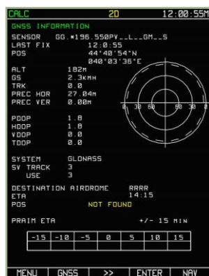
7-108 : Message d'erreur signalant que l'indicatif (RRRR) n'est pas un indicatif valide pour l'ABRIS
