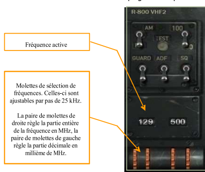
14-1 : Système radio VHF R-800
