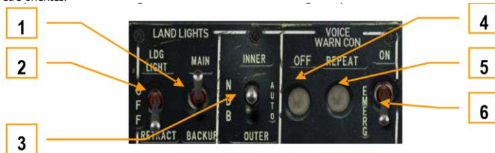
6-41 : Panneau de contrôle des phares d'atterrissage et des alertes vocales ("Betty")
