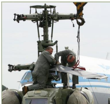
2-4 : Assemblage du rotor principal
