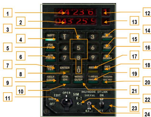
6-42 : Panneau de contrôle de navigation PVI-800
