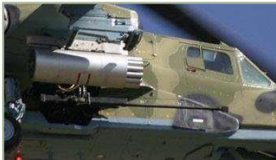
1-6 : Canon de 30mm 2A42 30 sur le Ka-50 Une autre particularité du V-80 était d'être monoplacement, sans espace disponible pour aménager un poste de tireur. Ce fut rendu
