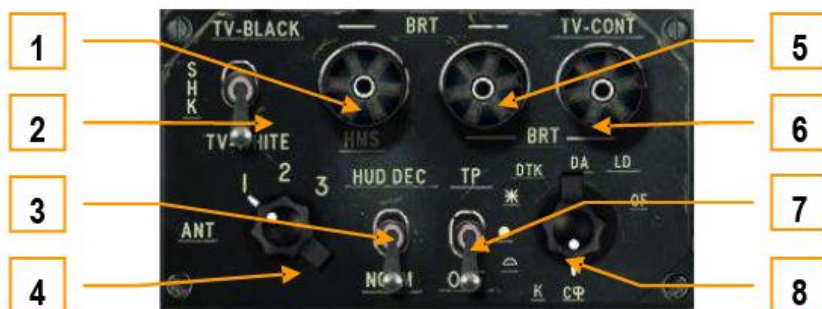
6-40 : Panneau de contrôle de l'écran d'acquisition de cible
