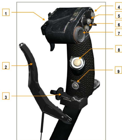
6-4 : Poignée de contrôle de pas cyclique
