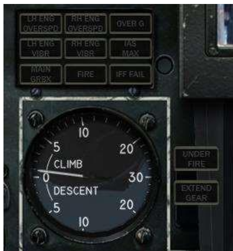
6-28 : Panneau d'alertes lumineuses
