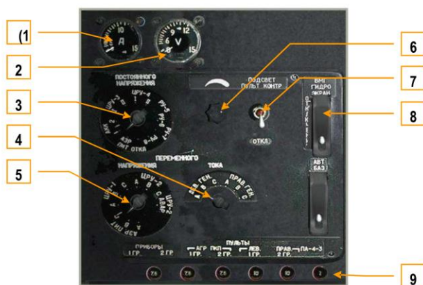
6-71 : Panneau de contrôle du système électrique
