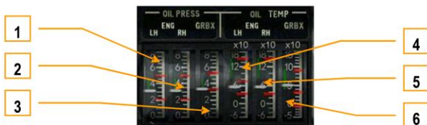
6-57 : Jauges de pression/température de l'huile de transmission et des moteurs
