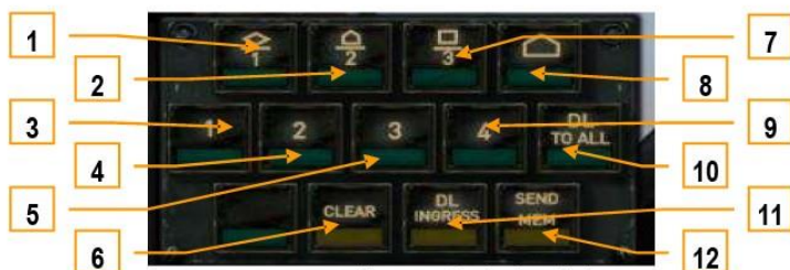
6-32 : Panneau de contrôle du data link
